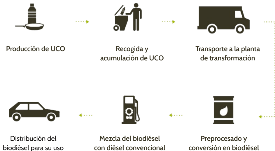
Fig. 2.1 Esquema la cadena de transformación de UCO a biodiésel.
