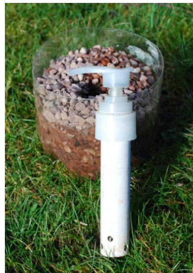
Aquí se muestra un tubo perforado alrededor del tubo de la bomba, cuya finalidad es evitar la obstrucción (véase “Material”)
